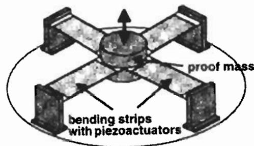
Abb. 3.11: Verwendung von piezokeramischen Streifenaktoren zur Erzeugung einer Punktkraft
