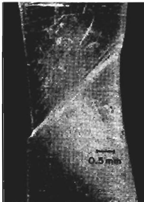
Abb. 2.6: Zugversuch an einem Al-Cu-Einkristall, aus LISIECKI ET AL. [LNA82]
