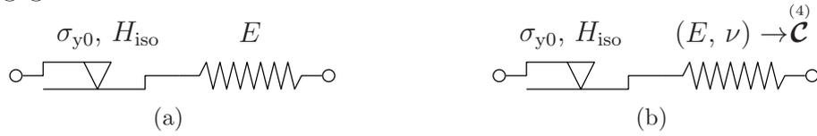
Abbildung 4.4: Elastoplastischer Körper mit zugeordneten Materialparametern, ein-dimensional (a), Verallgemeinerung (b)
